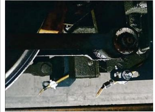
Abb. 3: Anordnung der Düsen links und rechts.
