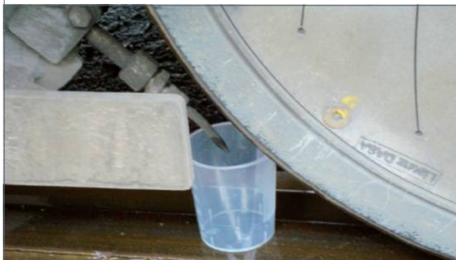
BILD 1: Messung der Sprühmengen auf dem Schienenkopf (Quelle aller Bilder: Autor)
