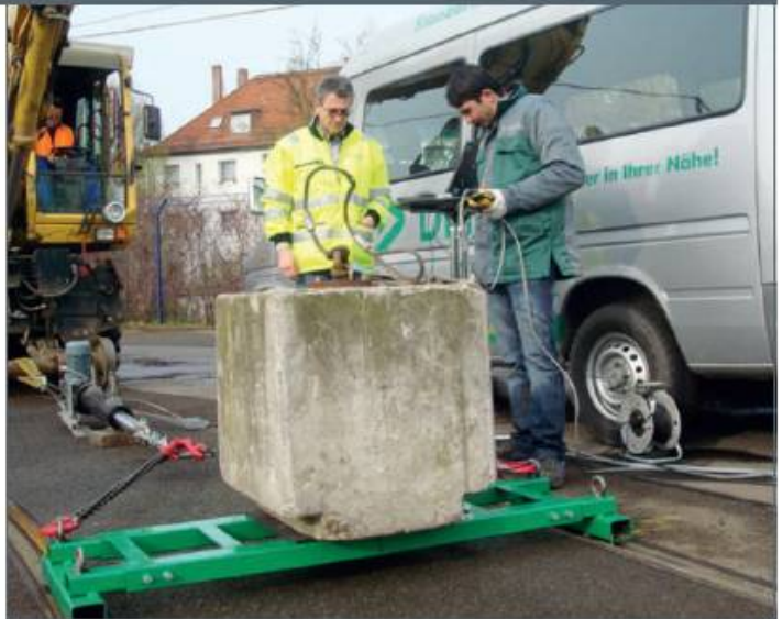
BILD 2: Reibwertmessungen (Als Reibpartner auf dem Schienenkopf wurden Gummireifenteile eingesetzt)
