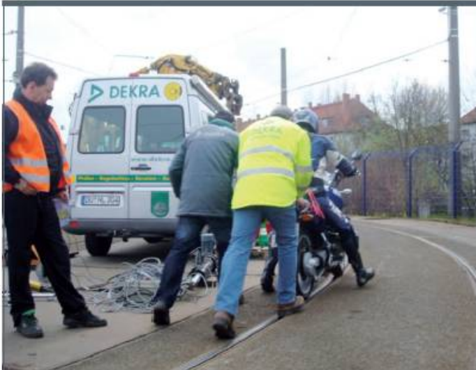
BILD 3: Überrollen des konditionieren Kurvenabschnittes
