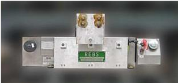
Sprühsystem mit Kompressor-Zentrale im Drehgestell
