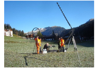
Lärmmessungen mit akustischen Kameras.
